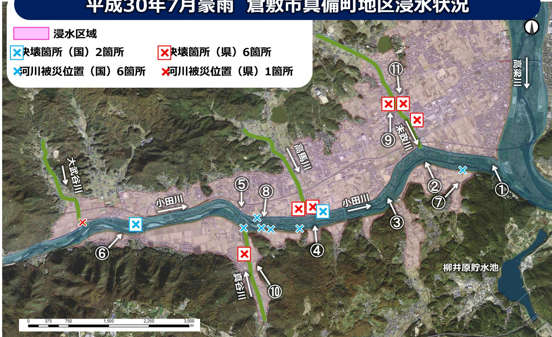
国管理河川の小田川をはじめ、県管理河川の末政川・高馬川・真谷川において堤防が8か所で決壊・7か所で一部損壊・損傷し、約1,200ヘクタールが完全に水没した
